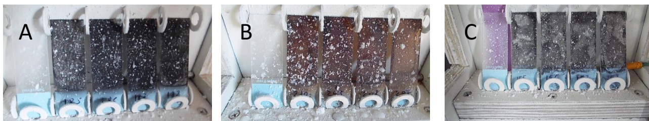
Figura 1. Imagini de pe inregistrările video ale filmelor hibride in timpul testului cu ceata simulata (64% umiditate, -18^{\circ}\text{C} )
